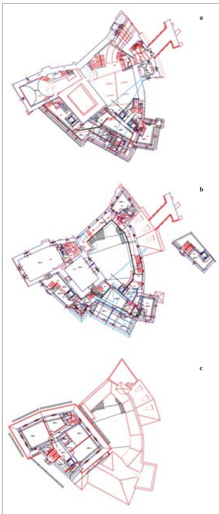
10. Rzuty zamku w Korkkwi: poziom dziedzińca (a), 1 piętra (b), poddasza (c); projekt odbudowy. Oprac. zespół architektów pod kierunkiem J. Wrzaka, 2002 r.
